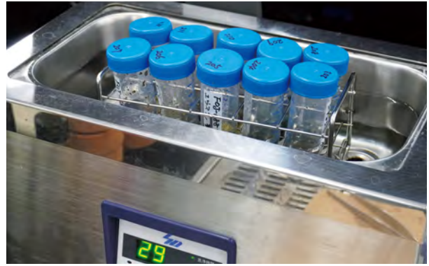
図5. 超音波処理中のサンプル.
