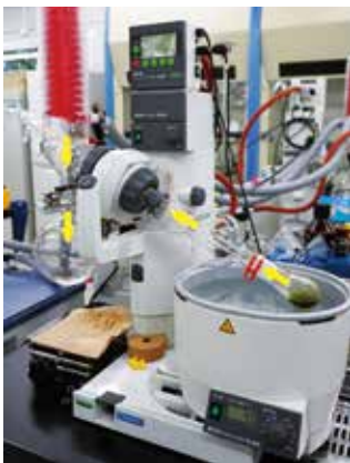
図 11. ロータリーエバポレーター。 矢印は水とエタノールの流れを示す。
